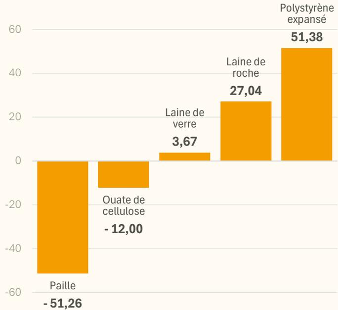
Emissions de gaz à effet de serre de matériaux isolants en sortie d'usine, en kg CO<sub>2</sub> eq/m<sup>2</sup> et pour R=7 m<sup>2</sup> K/W.
