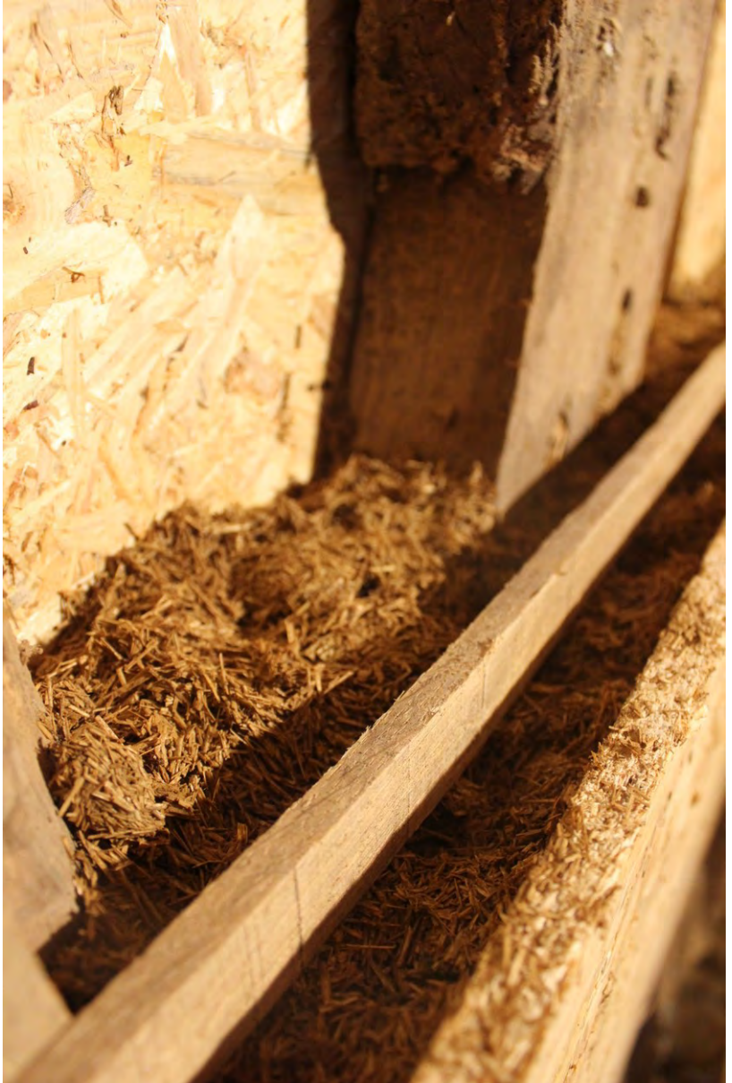
Figure 37: Test 2 : terre allégée bien tassée
