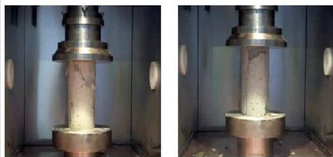
17 Essais de compression sur le béton de lin – sources : crédit photo CoDEM Picardie http://codempicardie.com/
