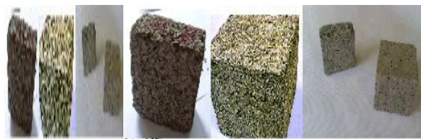
26 Blocs de béton de bois – source CoDEM
