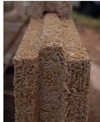
Illustration 35: Brique de chanvre à rainure languette pour limiter le pont thermique lié au joint, et permettre des montages à sec. Crédits : Sauvageot
