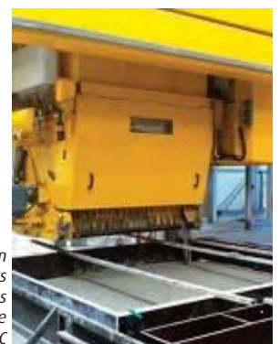
Ligne de fabrication d'éléments préfabriqués de grande dimension MNBC
