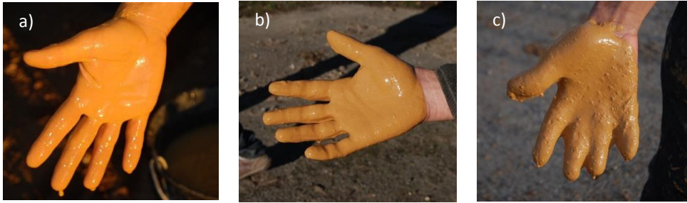
Figure 4-1: Le test du "gant" réalisé sur chantier. a) la barbotine est trop fluide, la main transparait clairement à travers ; b) la formulation de la barbotine est correcte lorsqu'elle forme un gant parfait sur la main, sans transparence de celle-ci ; c) la barbotine est trop grasse lorsque les doigts sont palmés et le gant trop épais.
