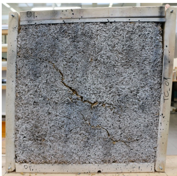
Figure 7-5: à gauche, exemple de cadre de terre chanvre cisailé; à droite, courbes types de trois échantillons testés.
