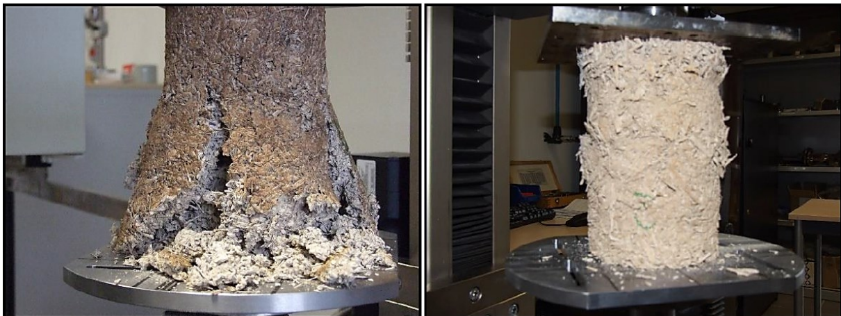
Figure 6-4: À gauche, terre tournesol (moelle et écorce), après rupture. à droite, terre colza, densification sans rupture [137].
