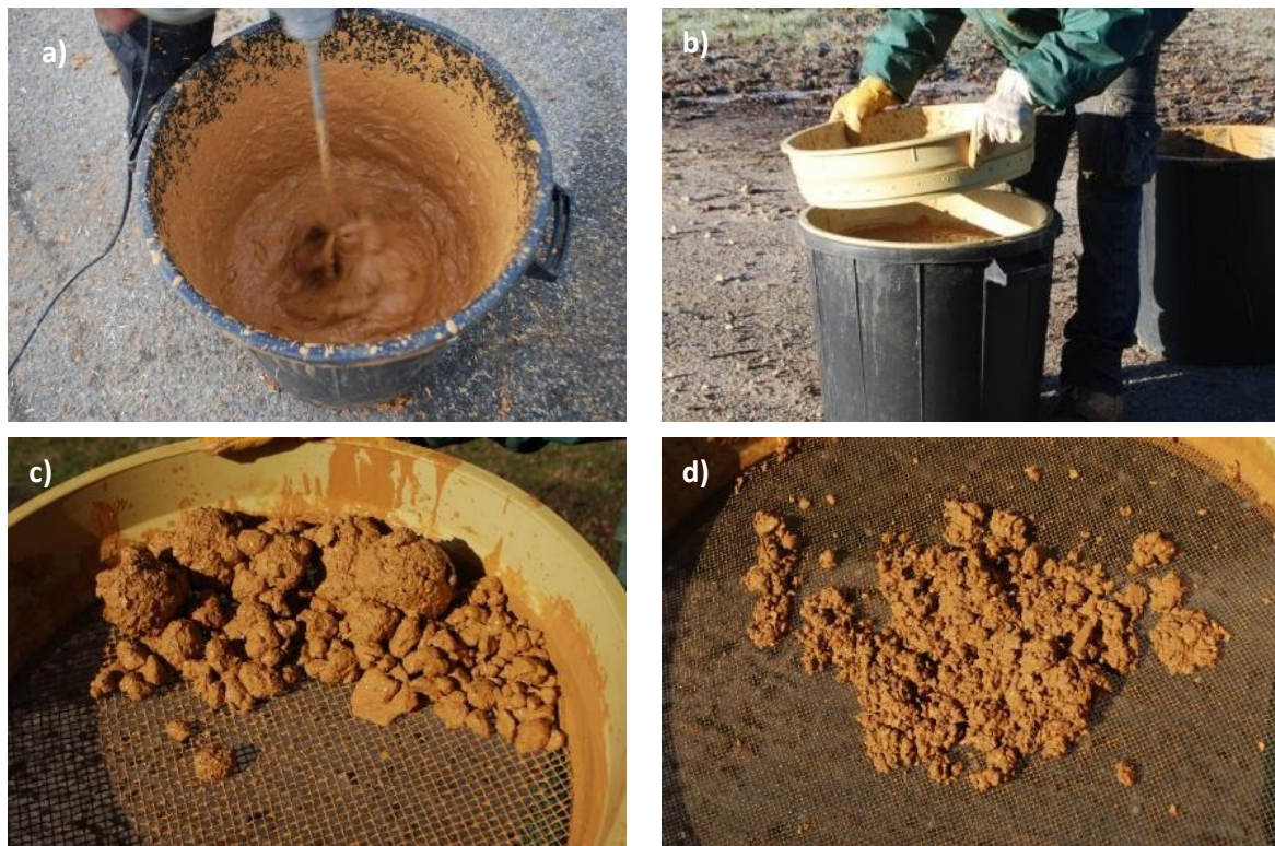
Figure 3-3: a) Mélange de la terre brute et de l'eau, b) tamisage, c) Refus du tamis de 6mm, d) Refus du tamis de 2mm.
