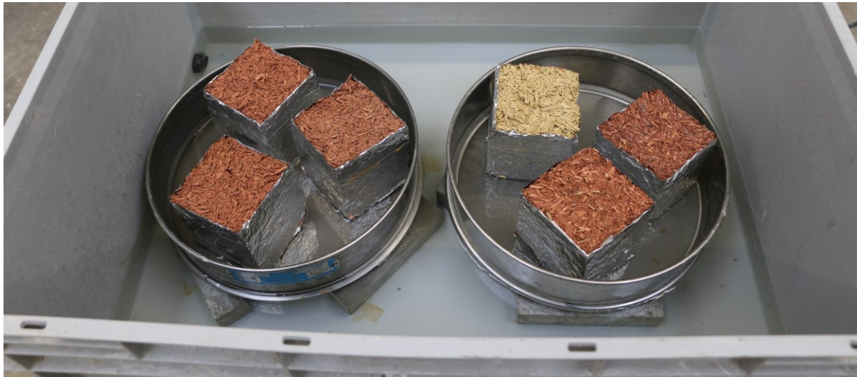
Figure 5-2 : Dispositif d'essai d'absorption capillaire.
