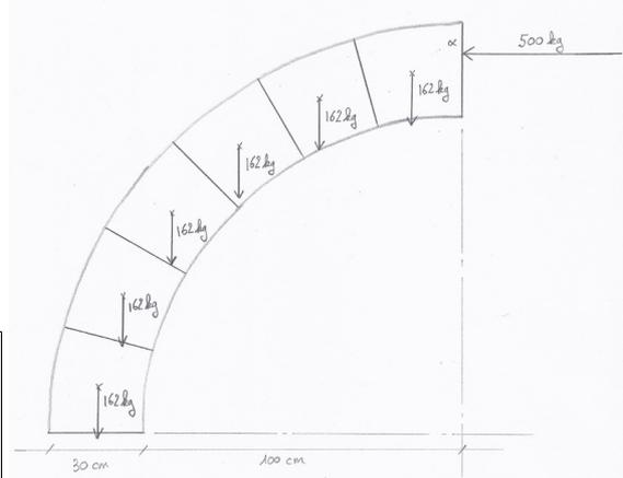
Figure 16 : découpage de la demi-voûte, calcul des masses et choix de la poussée P'
