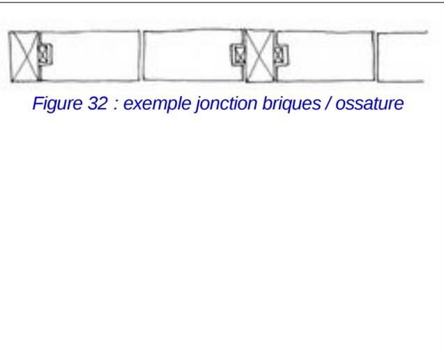
Figure 32 : exemple jonction briques / ossature
