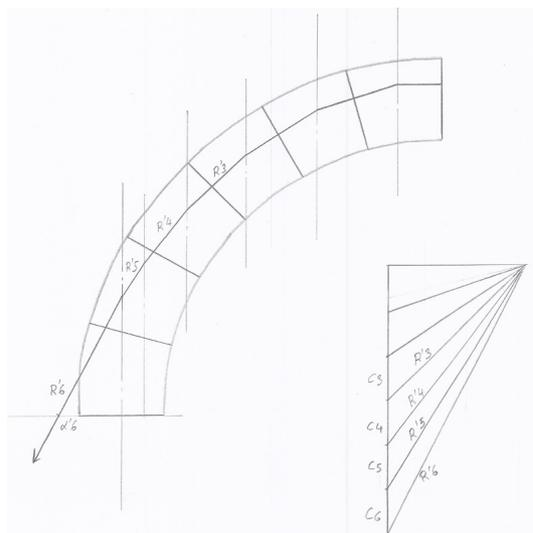
Figure 20 : Détermination graphique de la ligne de pression
