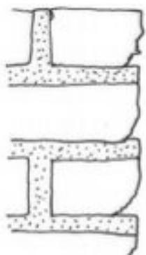
Figure 35 : exemple d'érosion avec joints plus dures que les briques
