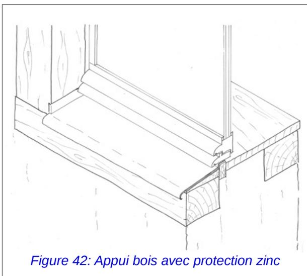
*Figure 42: Appui bois avec protection zinc*
