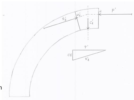
Tracer R'1 au départ de l'intersection entre la verticale passant par le centre de gravité (C1) et l'horizontale passant par le point d'application de la poussée P'. Cela donne le point d'application  $\alpha'1$  de R'1.
