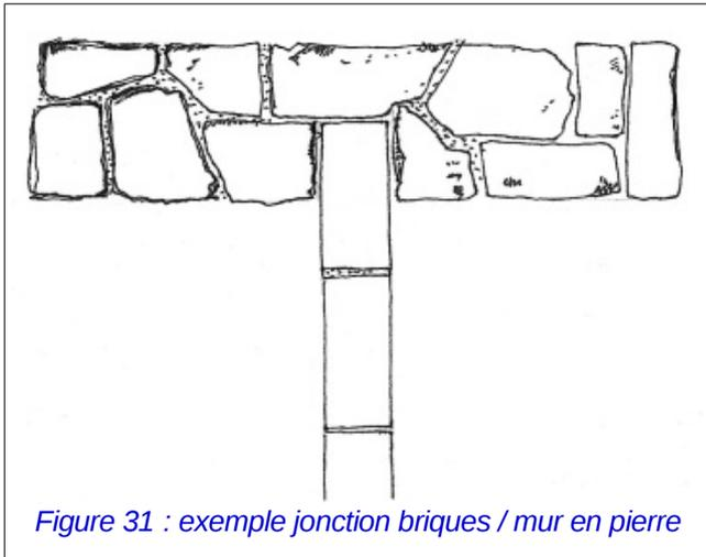
Figure 31 : exemple jonction briques / mur en pierre
