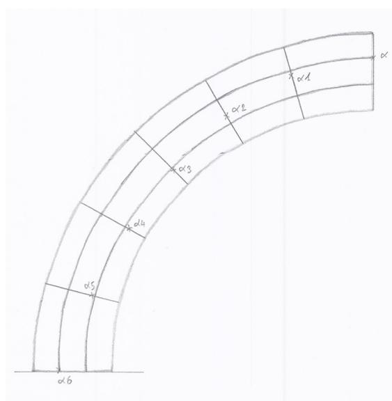
Figure 22 : Vérification du passage de la ligne de pression dans le tiers central
