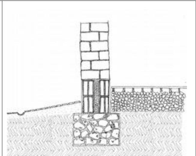
Figure 24 : Fondation béton cyclopéen, soubassement blocs isolés, canal de drainage en pierre, plancher sur hérission
