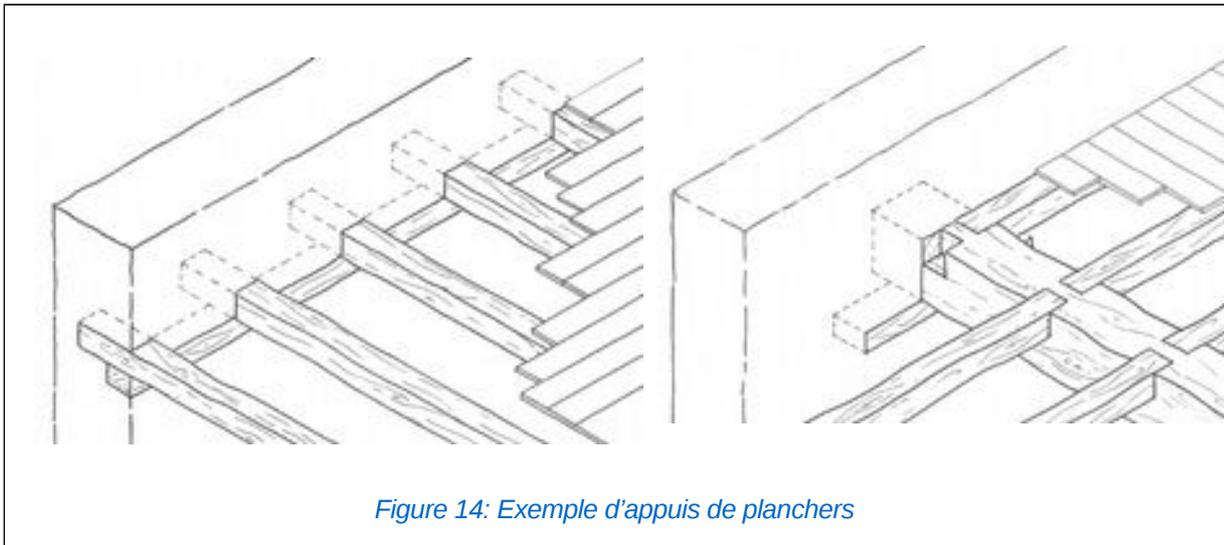
Figure 14: Exemple d'appuis de planchers
