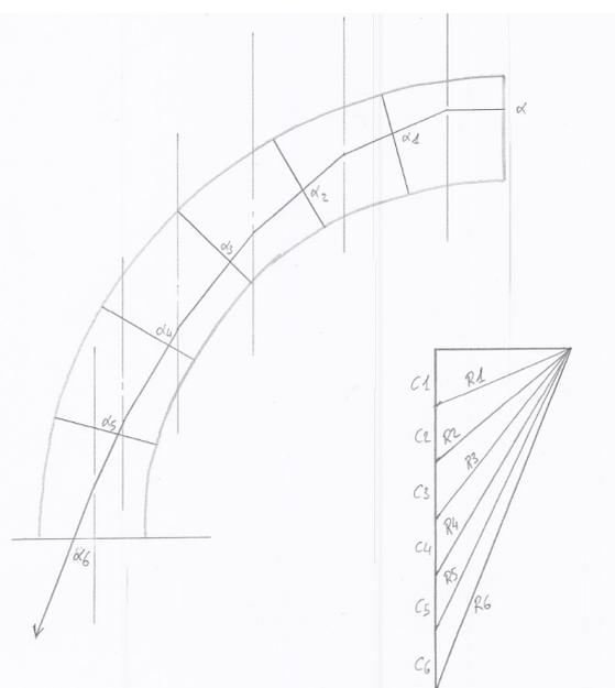
Figure 21 : Tracé de la ligne de pression passant par  $\alpha_6$
