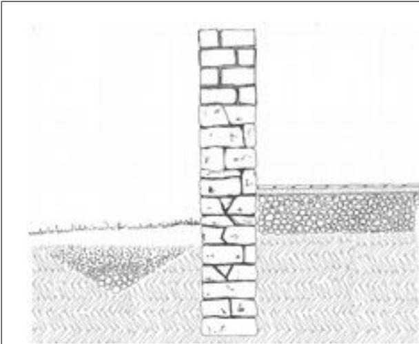
Figure 23: Fondation soubassement en pierres maçonnées, drain enterré, tomettes sur dalle chaux et hérission
