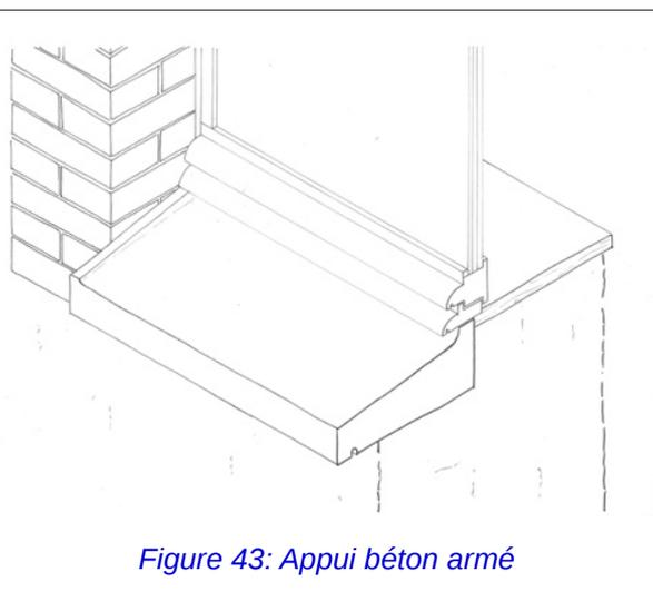
*Figure 43: Appui béton armé*
