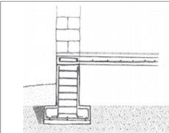
Figure 25 : Fondation-soubassement en Béton armé, drain PVC, sol : finition carrelage sur chape ciment, dalle béton armé et vide sanitaire
