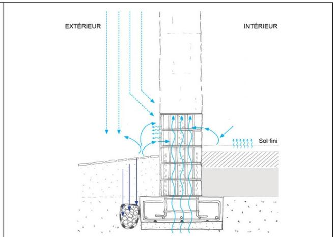
Figure 26 : Fondation béton armé, soubassement briques isolantes, drain : gravier + géotextile, sol : hérission, géotextile, pierres sur lit de sable.
